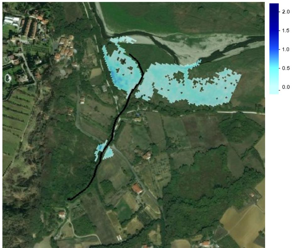
**Figura 4-43 Esondazioni massime Fosso di Monte per  $Tr=200$**
