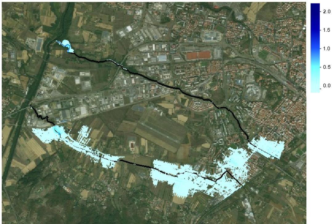
**Figura 4-105 Esondazioni per la parte di valle  $T_r=200$  anni a  $t=2h$**
