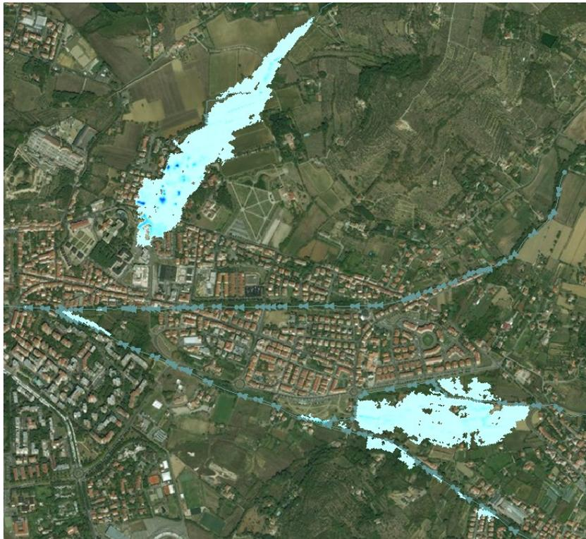
**Figura 5-10 Andamento delle esondazioni a  $t=2h:30min$  per  $Tr=30$  anni**
