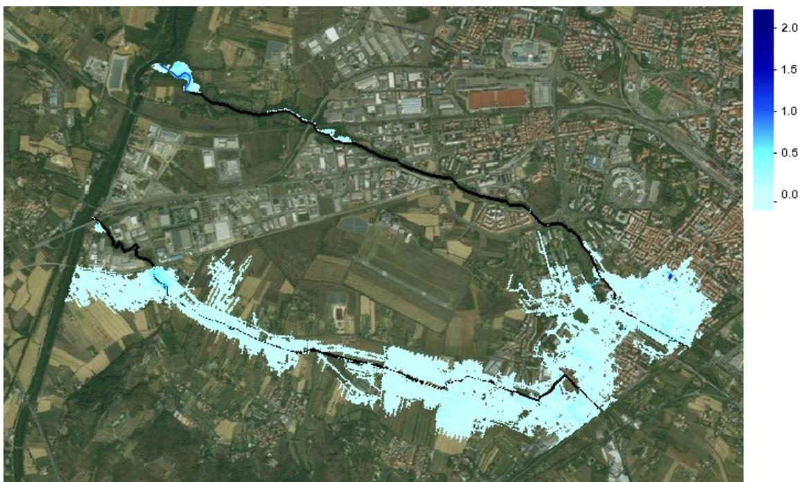
**Figura 4-106 Esondazioni massime per la parte di valle  $T_r=200$  anni**
