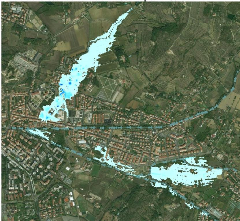
**Figura 5-11 Andamento delle esondazioni a  $t=3h:00min$  per  $Tr=30$  anni**
