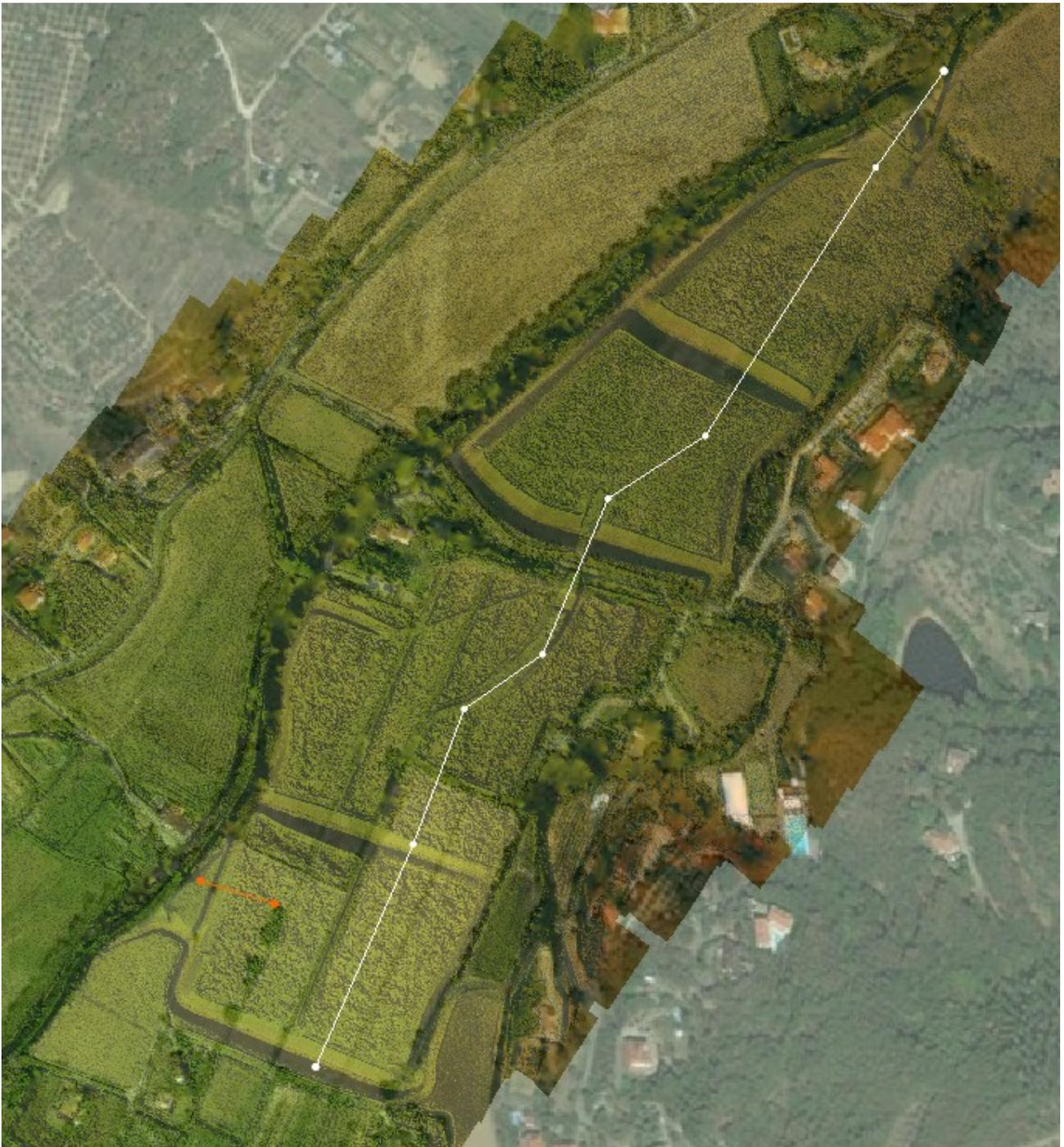
**Figura 4-67 Sezione generale (bianca) ed in prossimità dello sfioro di uscita (arancio)**
