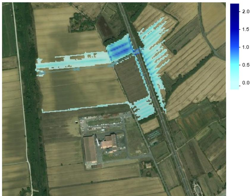
**Figura 4-29** Aree allagate per Tr30 anni dovute al fosso posto a nord dell'impianto AISA
