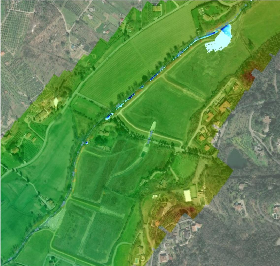
**Figura 4-72 Andamento delle esondazioni per  $T_r=200$  anni a  $t=1:10h$**
