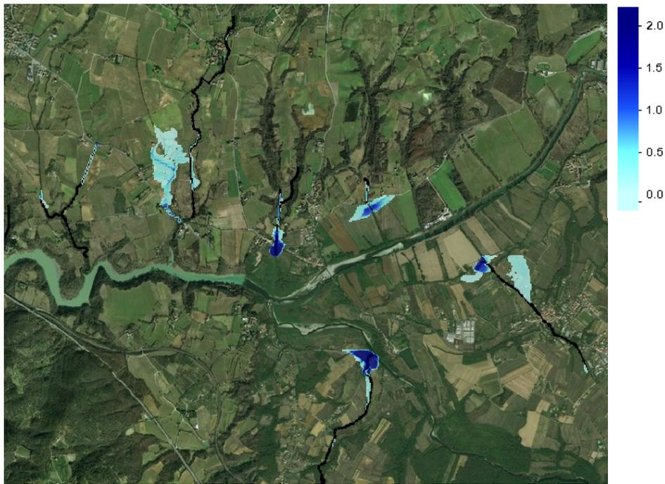
**Figura 4-42 Esondazioni massime per  $Tr=200$**
