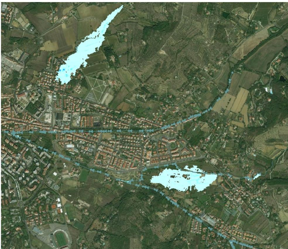
Figura 5-9 Andamento delle esondazioni a  $t=2h:00min$  per  $Tr=30$  anni
