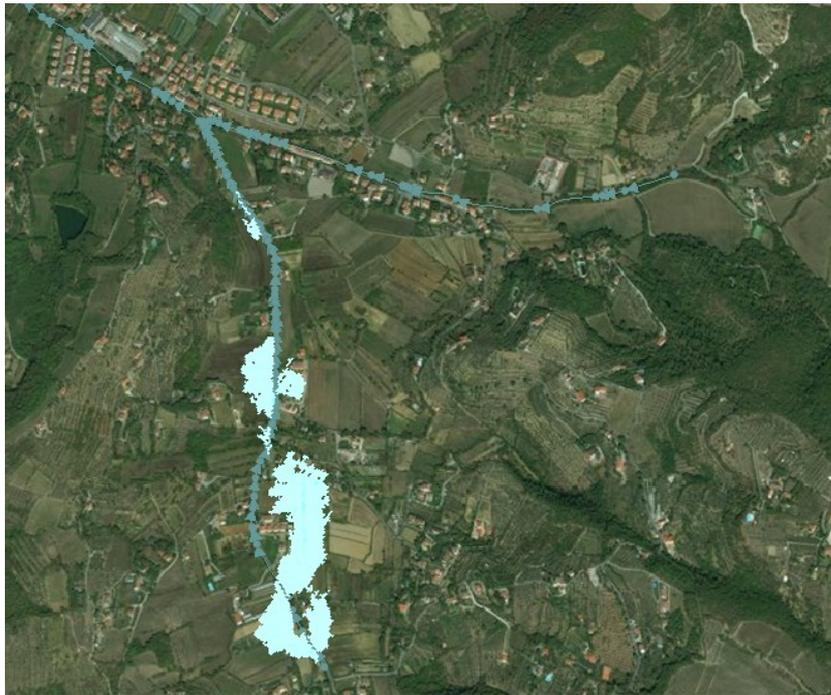
**Figura 5-15 Andamento delle esondazioni Covole e Peneto a t=1h:30min per Tr=30 anni**
