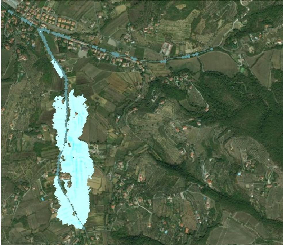
**Figura 5-16** Andamento delle esondazioni Covole e Peneto a t=2h:00min per Tr=30 anni
