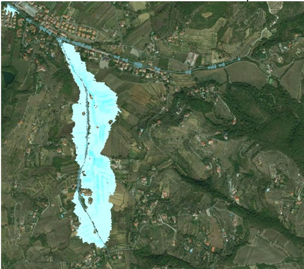
**Figura 5-17** Esondazioni massime per Tr30 anni per Covole e Peneto
