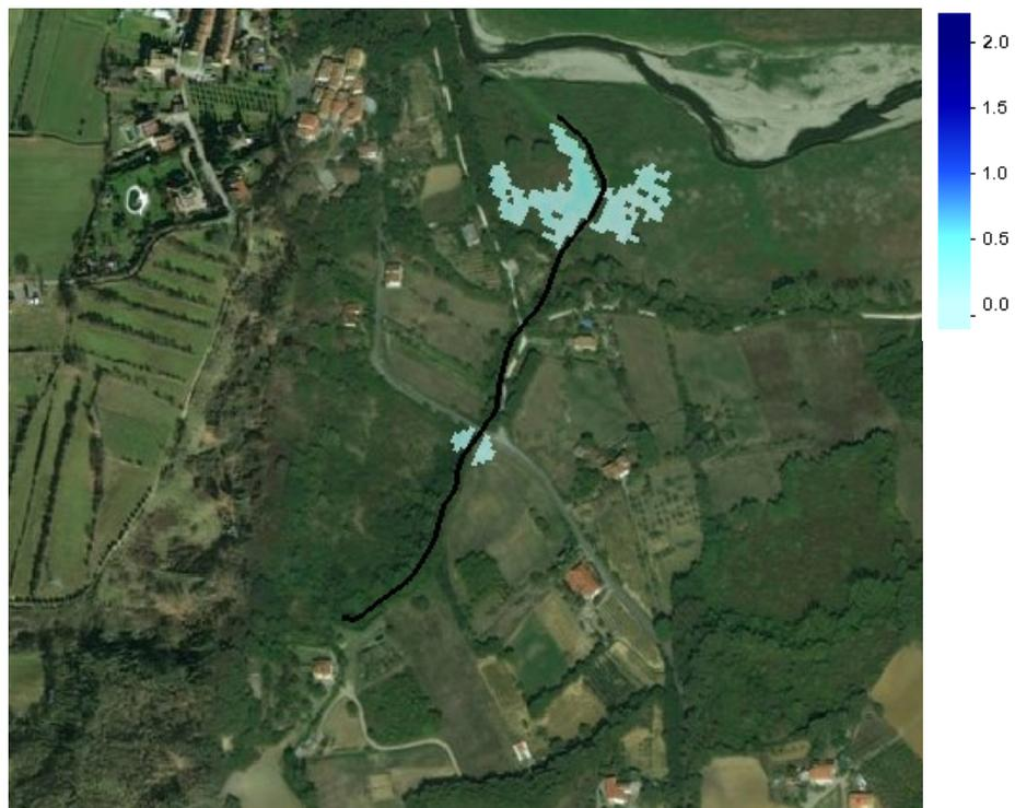
Figura 4-44 Esondazioni massime Fosso di Monte per Tr=30
