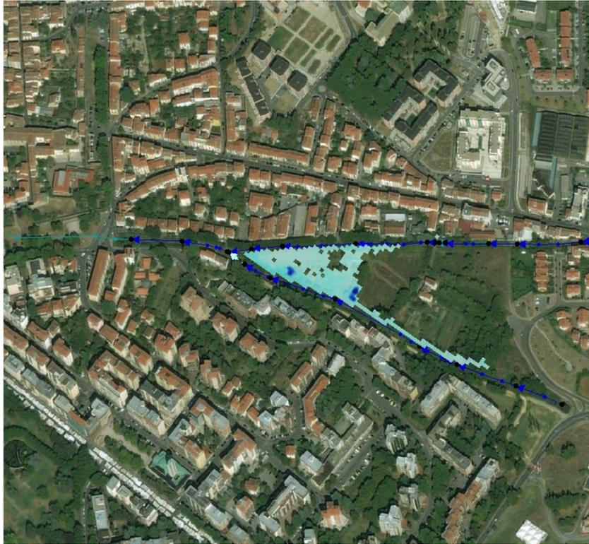
**Figura 5-4 Esondazioni per Tr30 a t=2h e 00 min**
