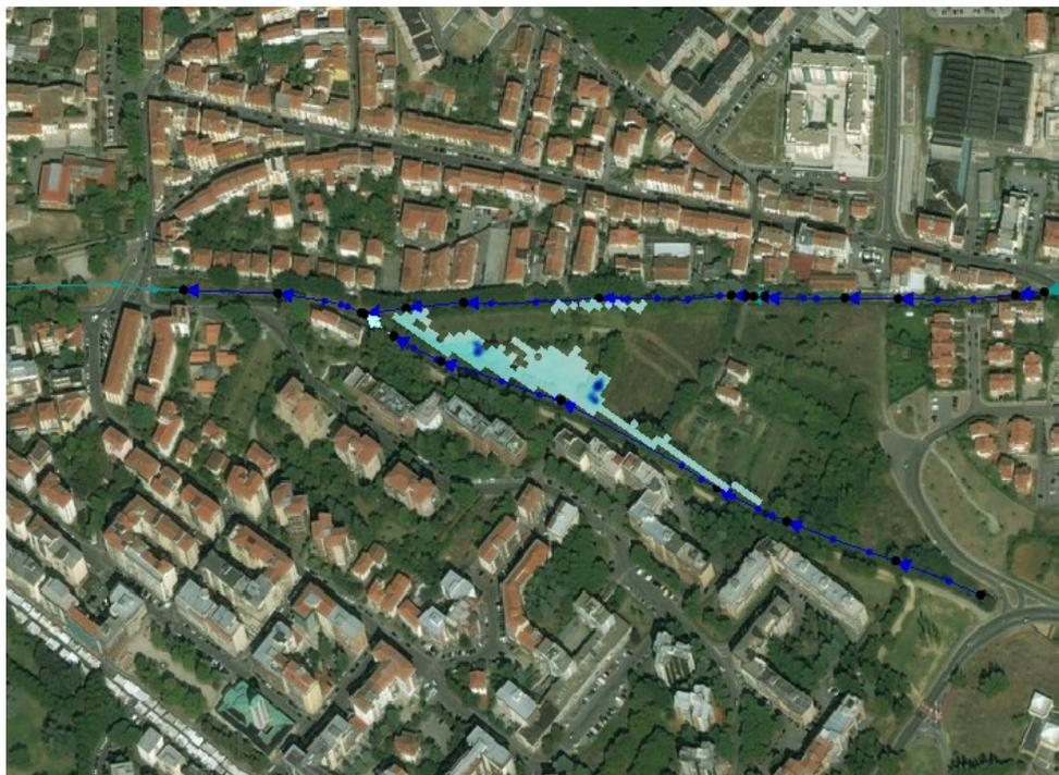
Figura 5-3 Esondazioni per Tr30 a t=1h e 50 min
