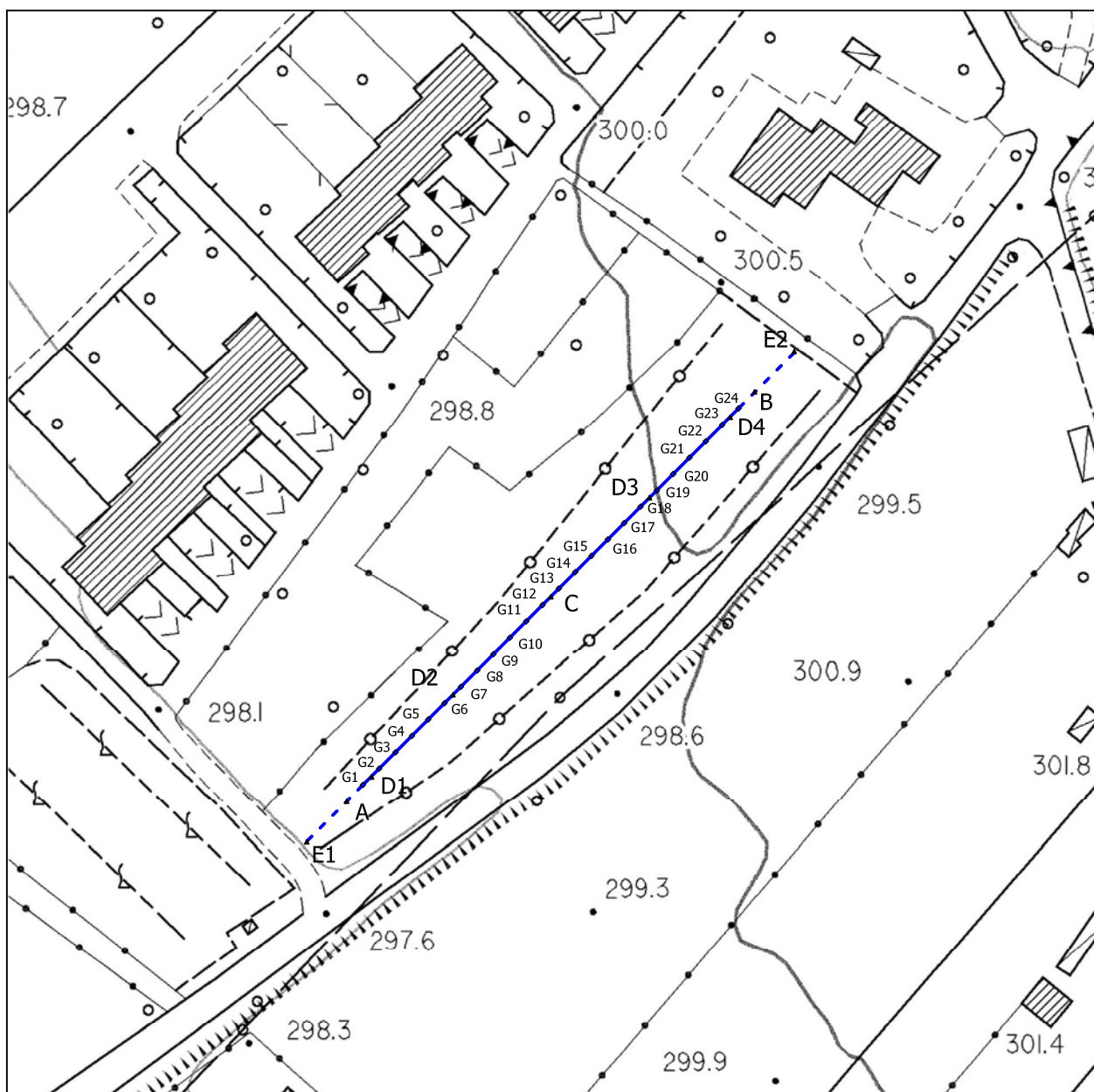
PROSPEZIONE SISMICA A RIFRAZIONE (SR_4) CON ONDE P E SH
