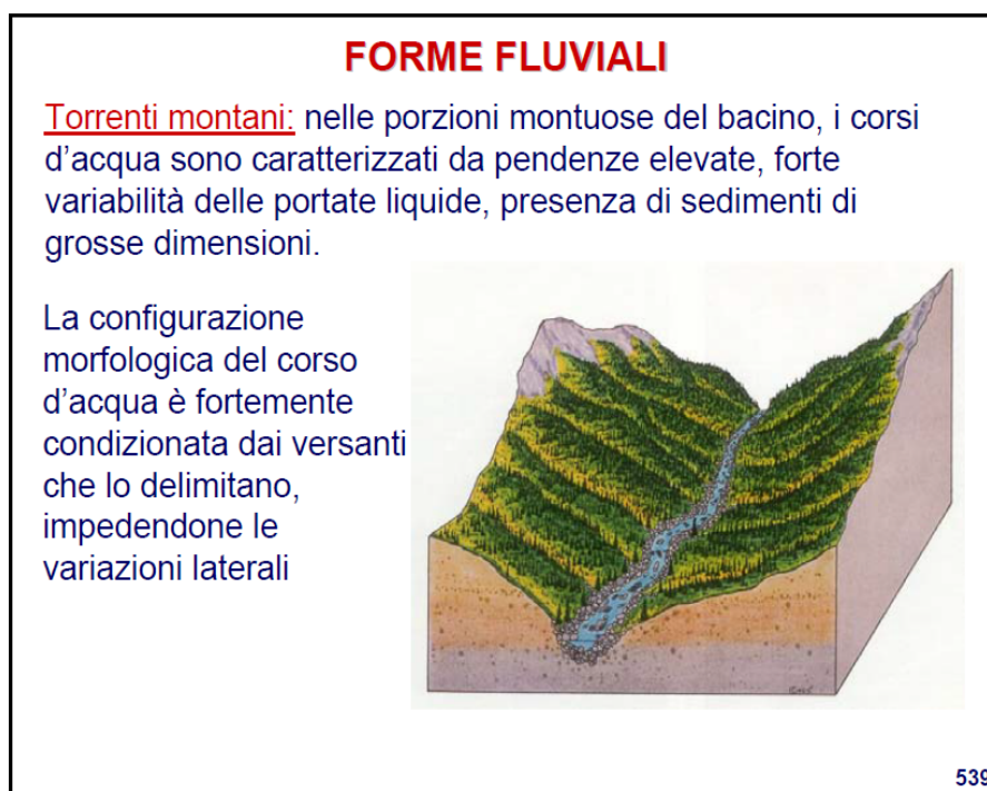
Figura 14: nelle porzioni montuose del bacino, i corsi d'acqua sono caratterizzati da pendenze elevate, forte variabilità delle portate liquide, presenza di sedimenti grossolani o alvei scolpiti sul substrato roccioso. La configurazione morfologica del corso d'acqua è fortemente condizionata dai versanti che lo delimitano, impedendone le variazioni laterali.
