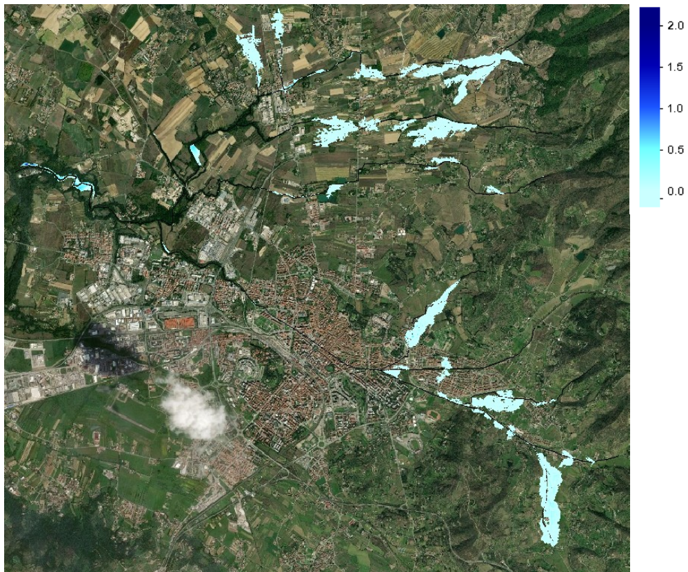
Figura 4-87 Esondazioni per l'intero reticolo del Torrente Castro T_r=200 anni a t=2h
