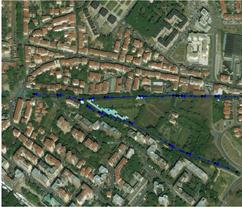
Figura 5-2 Esondazioni per Tr30 a t=1h e 40 min
