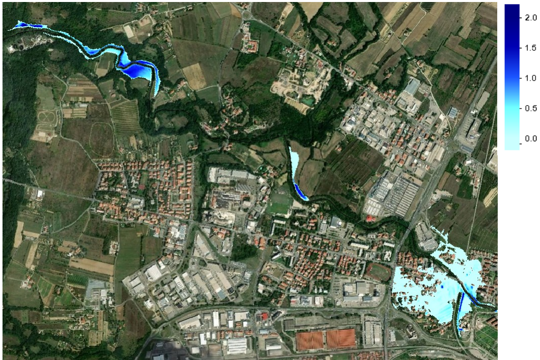
Figura 4-93 Esondazioni massime per la parte di valle del reticolo del Torrente Castro Tr=200 anni
