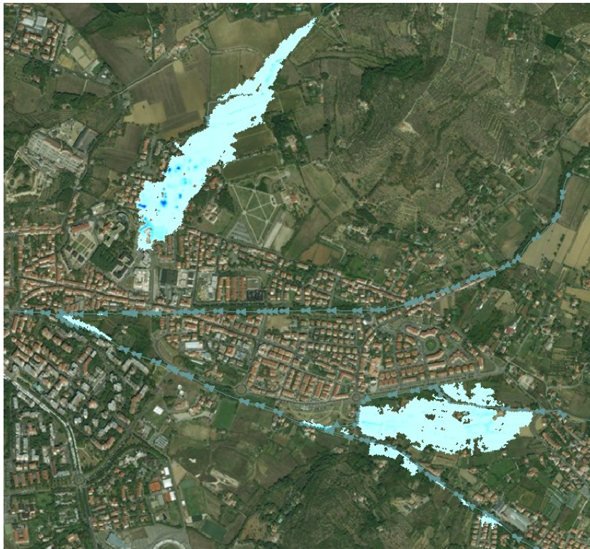
Figura 5-10 Andamento delle esondazioni a t=2h:30min per Tr=30 anni
