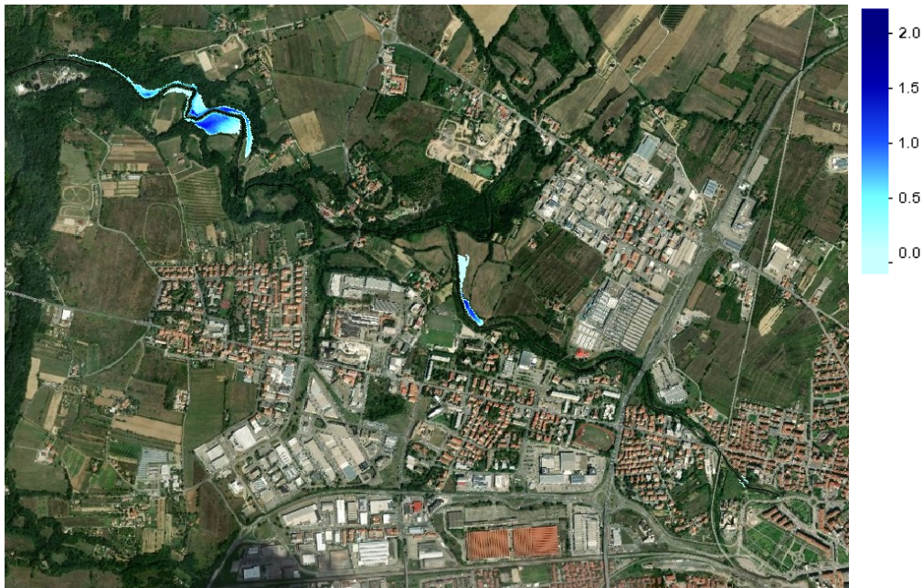
Figura 4-94 Esondazioni massime per la parte di valle del reticolo del Torrente Castro Tr=30 anni
