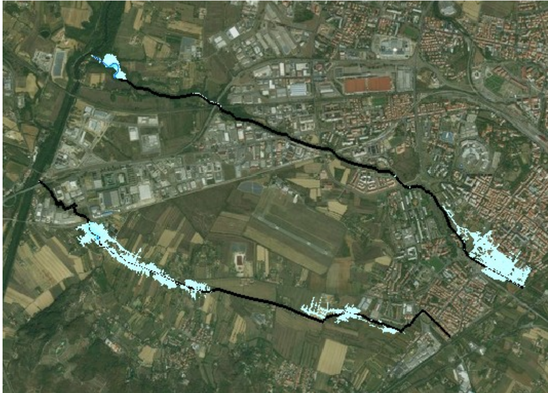
Figura 4-107 Esondazioni massime per la parte di valle T_r=30 anni
