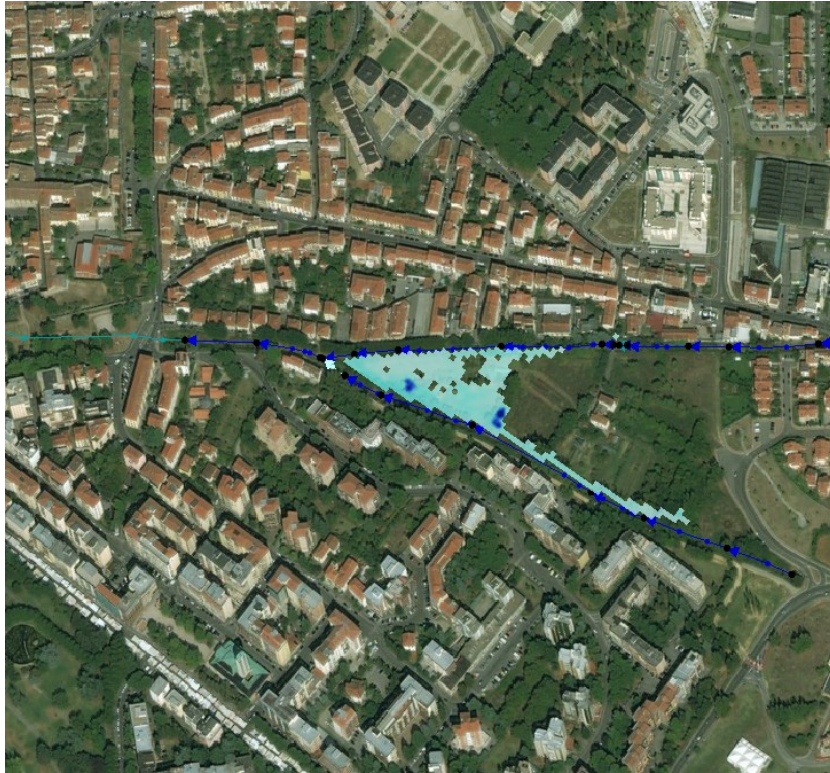
Figura 5-4 Esondazioni per Tr30 a t=2h e 00 min
