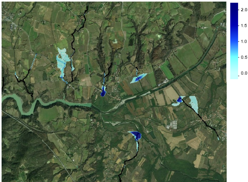
Figura 4-42 Esondazioni massime per Tr=200
