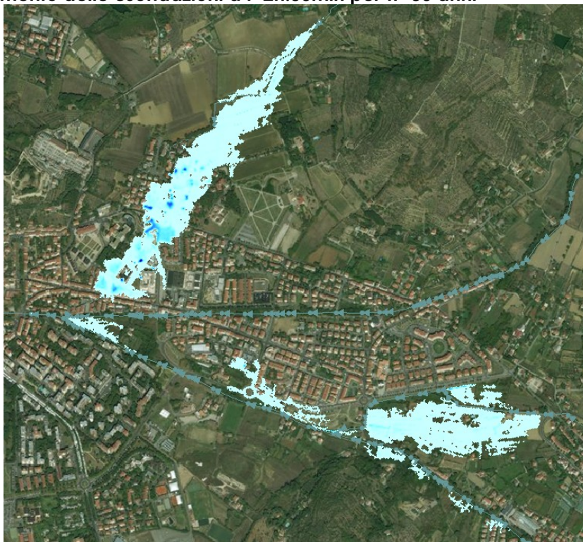
Figura 5-11 Andamento delle esondazioni a t=3h:00min per Tr=30 anni
