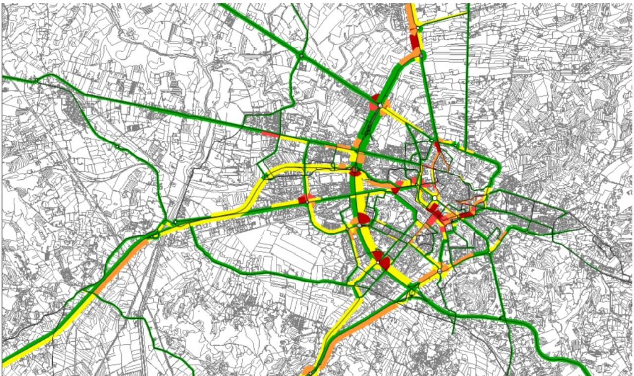
Figura 10: Grado di saturazione della rete stradale attuale
