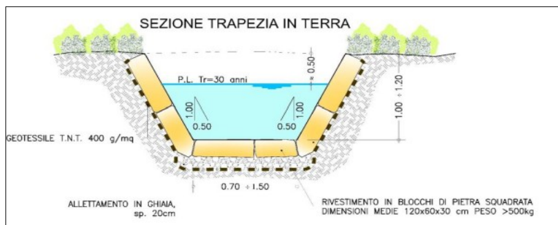
Figura 8: sezione tipo fosso Est. Estratto elaborato T-06.
