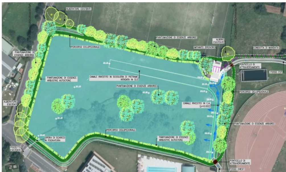
Figura 10: sistemazioni a verde e interventi di mitigazione paesaggistica della vasca volano (estratto tavola T-07).
