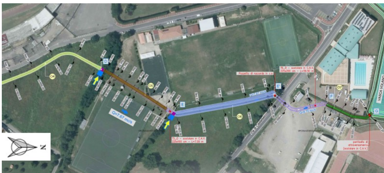
Figura 4: planimetria su fotomosaico del fosso Ovest (da prog. 0+550 a progr.0+950). Estratto elaborato T-05
